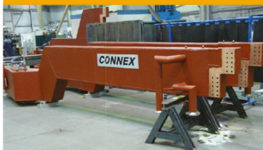
فازهای کوره های قوس الکتریکی از جنس مس-آهن و یا آلومینیوم و یا سیستم های بدنه آهنی بالوله های مسی
