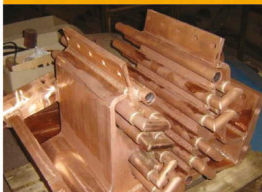
شینه های انتقال برق فشار قوی
